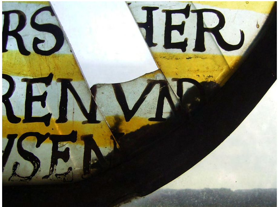
Abb. 26: Detail aus Abb. 25. Malschichtverluste am unteren Rand der untersten Schriftzeile
